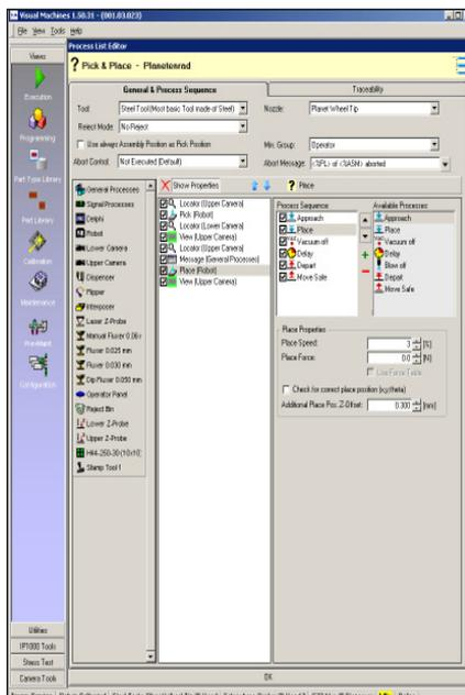
Alle Parameter, Funktionen und Konfigurationsdaten der gesamten IP-500 Tabletop werden über die bedienerfreundliche Software VisualMachines™ gesteuert. VisualMachines™ ist eine objektorientierte, offene und modulare Softwarelösung aus eigenem Haus.
